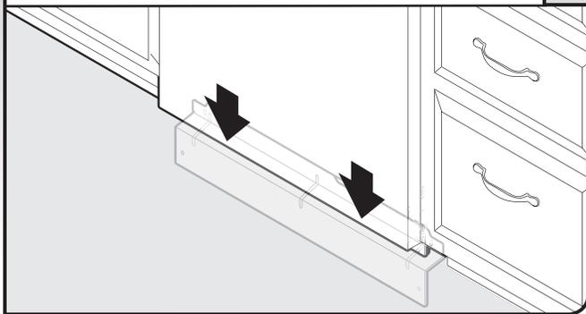
Vérifier que la rive inférieure du panneau inférieur est au contact du plancher. Le réajuster au besoin.
